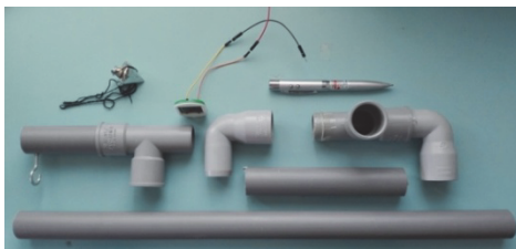
Εικόνα 8. Τα απαραίτητα υλικά και η διάταξη της Φωτοπύλης.
